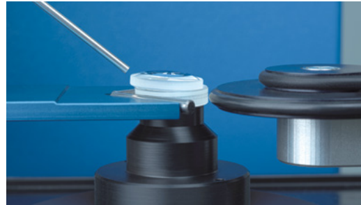
Linsenausrichtung mit LensAlign 2D Air auf einer Linsendrehvorrichtung
