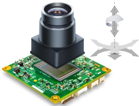
Abschließend wird der Kleber zwischen Objektiv und Kameragehäuse in einem separaten Prozess außerhalb der ProCam®Align Smart thermisch ausgehärtet. Eine weitere Besonderheit der Active Alignment Anlage ist die integrierte Kleberschrumpfkompensation. Denn der aufgetragene Klebstoff schrumpft im Aushärtungsprozess.
